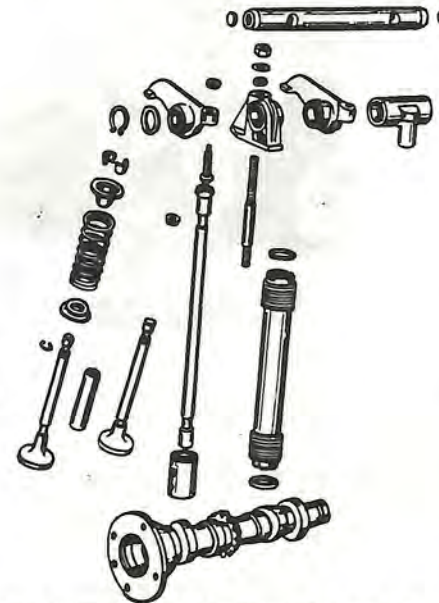
Bild 5 Nockenwelle und zerlegte Kipphebelteile mit Ventil und Ventilfedern und Zubehör
