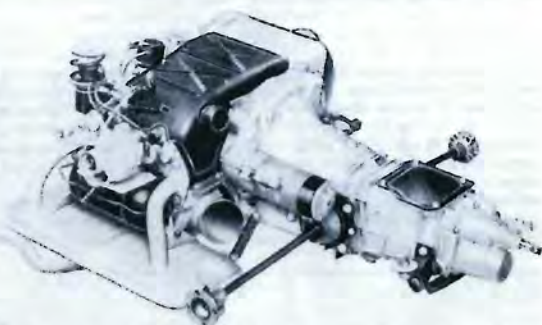
Genial war die Unterbringung des Motors im Gladrierra gelöst: Durch Kippen erhielt man einen Unterflur-Heckmotor mit liegenden Zylindern, wodurch eine durchgängige, ebene Ladefläche möglich wurde.
