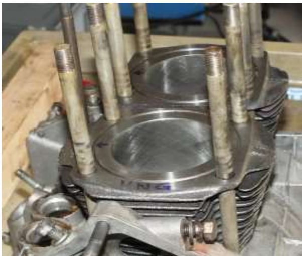
Revidierter Motor des Fiat 500 FL
